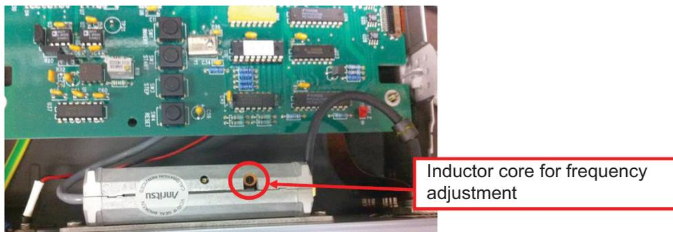
Figure 6-11. ML2419A Inductor Core
