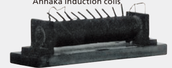
1903 (明治36年) 共電式自動電話機 Common-battery telephone 安中式インダクションコイル Annaka induction coils
