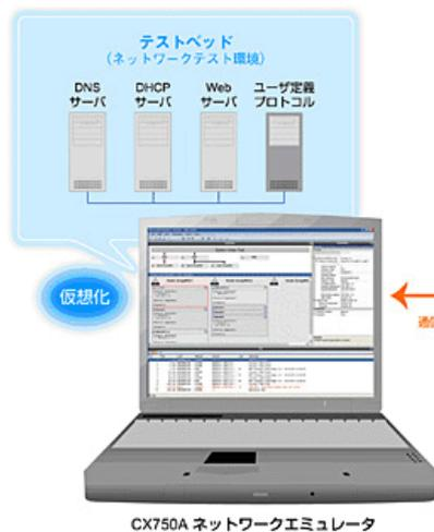
外出先から無線端末を利用してビデオの録画予約をする、セキュリティ機器からの映像を確認する。エレクトロニクス業界では、こうした便利で快適な社会づくりに向け、ネットワーク機能を搭載した家電や本格的なインターネット接続機能を有する無線端末の開発が進展しています。これらデジタル機器のネットワーク接続機能の評価を可能とする専用ツールが、アンリツエンジニアリング(株)の「ネットワークエミュレータ」です。通常ネットワーク接続機能は、ホストコンピュータや各種サーバなど、複数のコンピュータを実際に用意して評価されていますが、ネットワークエミュレータを利用することにより、1台のPCだけで試験が行えます。これにより、機材調達コストの削減はもちろんのこと、試験時の消費電力の大幅な削減に貢献いたします。たとえば、32台のノートPCを試験用機材として用いて1ヶ月間試験を行った場合、約2000kWhの電力が必要となりますが、CX750Aでは約70kWhの電力で試験が可能。お客さまの地球環境負荷低減にも貢献しています。
