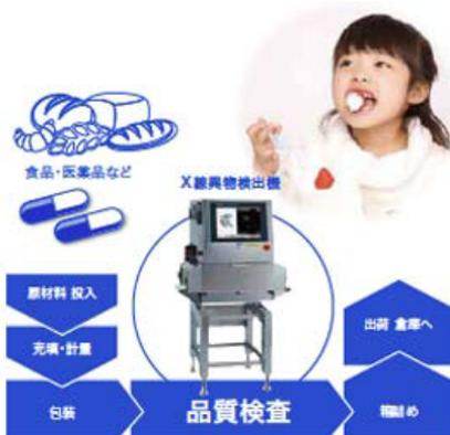
食品、医薬品にあってはならない品質不良。直接口にするものへの安全と安心は社会的な要請です。アンリツ産機システム(株)では、加工、包装、最終検査までの一連の工程で必要とされる検査機器を提供。原材料、内容量の正確な計量から加工時、包装時、出荷検査時における異物検出まで対応した製品が、国内外の食品メーカーのオートメーションラインに組み込まれています。
