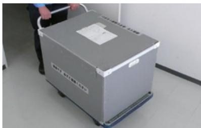
製品本体はキズやゴミが付着しないように保護用のポリエチレン袋を被せ、通い箱に収納します。製品本体と添付品箱は写真のような荷姿で持ち込みます。
