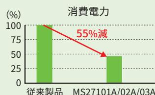
Anritsu Company (米国) は国内アンリツグループと同様に環境に配慮した製品の開発に取り組んでいますが、国内アンリツグループで運用している環境配慮型製品制度は導入していませんでした。グローバル環境管理会議などを通して、2014年度にグローバル製品アセスメント基準の統一を実施しましたが、それに伴い、環境配慮型製品制度も導入しました。2015年度に海外グループ会社の開発製品では初めてリモートスペクトラムモニター MS27101A/02A/03Aをエクセレント エコ製品に認定しました。MS27101A/02A/03Aはグローバル製品アセスメントの基本項目(体積、質量や消費電力など)の中でも、特に製品のライフサイクルにおけるCO<sub>2</sub>排出量削減に効果のある消費電力の低減を重視し、従来製品と比較して55%の削減を達成しています。
