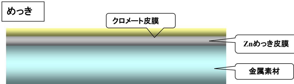
クロメート皮膜，Znめっき皮膜，金属素材の各々が均質材料となります
