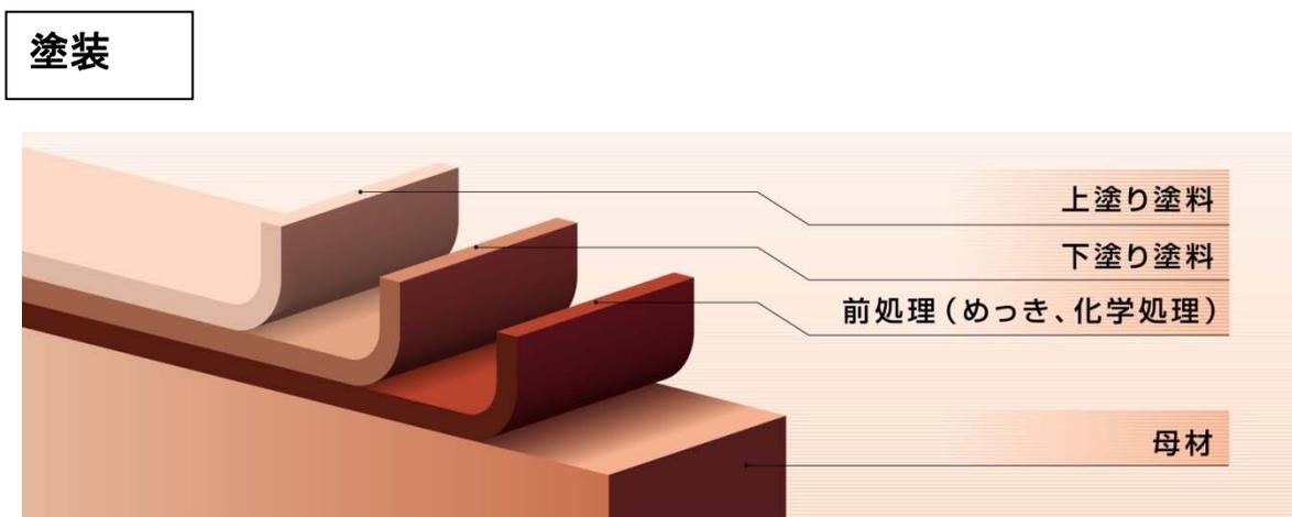
上塗り塗料，下塗り塗料，前処理，母材の各々が均質材料となります
