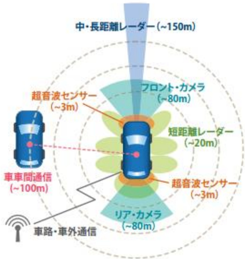
図1. 自動車安全のためのシステム構成(例)
