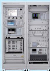
LTEコンフォーマンス・テストシステム (LTE/LTE-Advanced端末が国際標準規格に適合していることを検証するためのテストシステム。業界最多の試験項目を提供している。)
