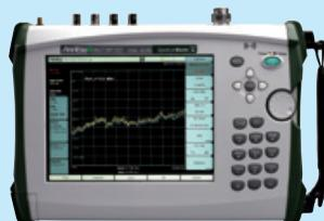
ハンドヘルド・スペクトラムアナライザ (小型・軽量で測定現場に簡易に持ち運べる信号解析器。屋外での電波の品質測定に使用される。)
