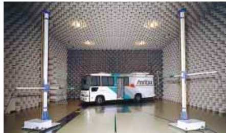
10m法電波暗室
