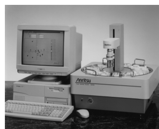
図1 人工脂質膜を用いたマルチチャンネル型味センサの概要 Taste sensor using multichannel lipid membranes
