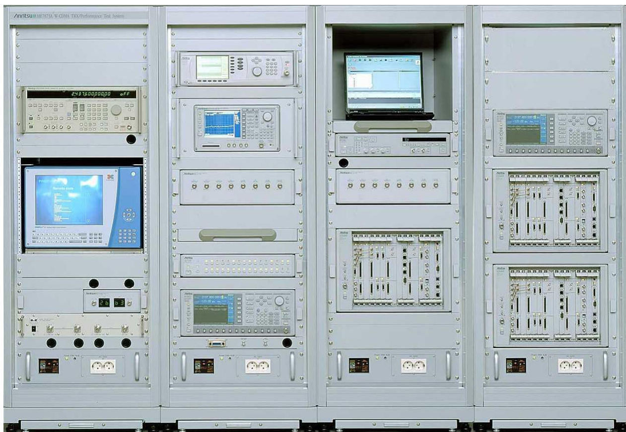
図 1 ME7873A(opt10 付)RF コンフォーマンステストシステムの外観 External view of ME7873A RF Conformance Test System (with Option 10)
