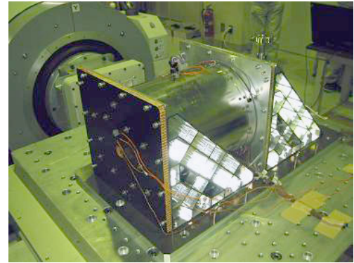
図 8 正弦波振動試験 Sinusoidal vibration test
