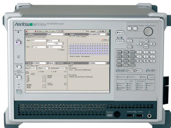
図 1 MP1595A 40G SDH/SONET アナライザ外観
