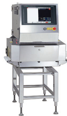
図 1.1 デュアルエナジーセンサ搭載 X 線異物検出機の外観
