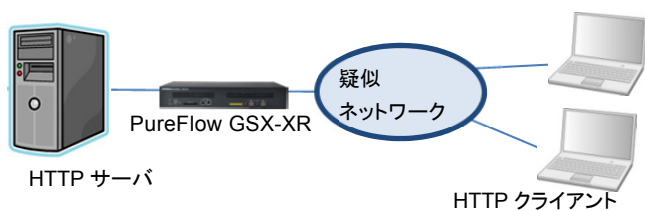
図 12 試験構成 2(帯域制御あり) Test network 2 (With Traffic shaping)
