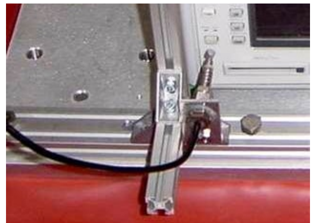
図 6 パネルキーの遠隔操作 Panel key operation equipment
