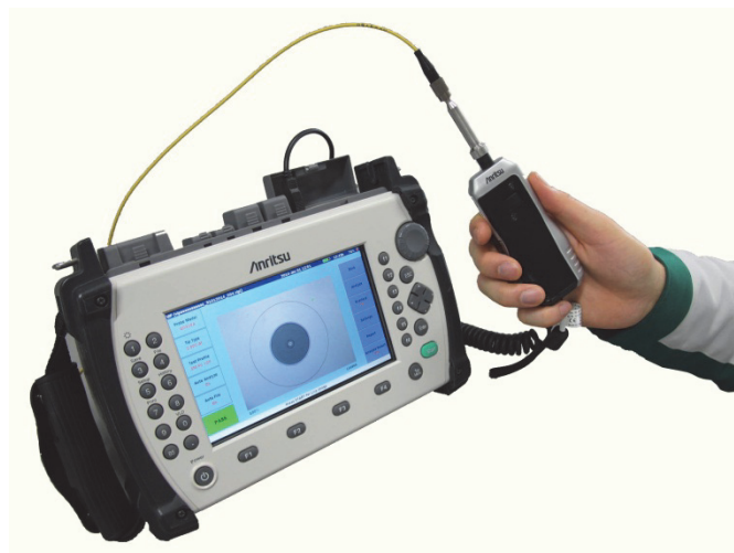
図 10 G0306A ファイバースコープ使用例 An Example of use G0306A Fiber Scope
