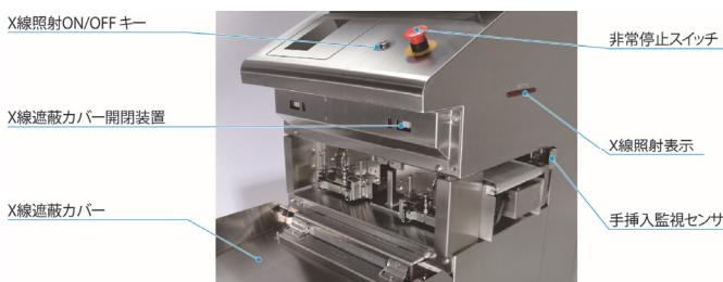
図9 X線検査機の安全装置
