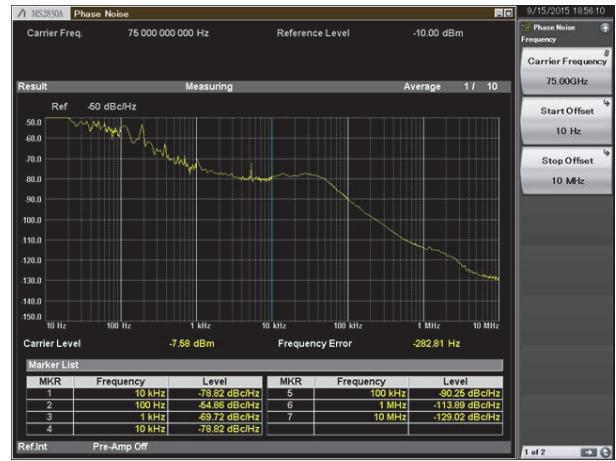
図 17 CW:75 GHz 入力時の位相雑音測定結果例
