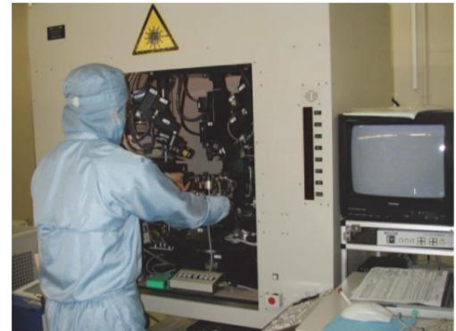
図 5 光ファイバ溶接固定装置
