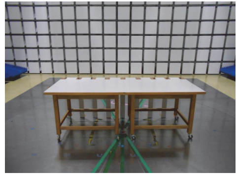
図 8 測定テーブル設置例:床面 (自動車部品用 長さ 2.5 m)
