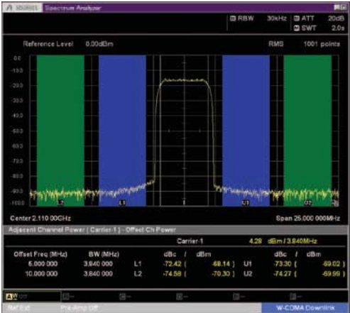
W-CDMA ACLR, 1 Carrier (TestModel1, 64DPCH)
