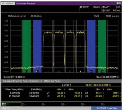
W-CDMA ACLR, 4 Carrier (TestModel1, 64DPCH)
