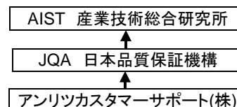
図4 レーザパワーのトレーサビリティ体系図
