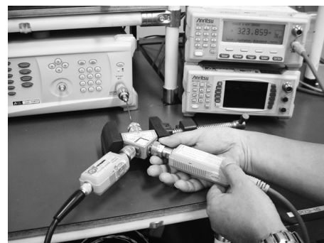
取り替え同時比較法によるパワーメータの較正
