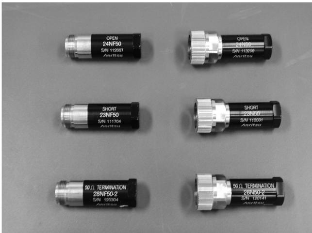
写真2 較正キットの例 (N型-FemaleとN型-Male : 上から Open, Short, Load)
