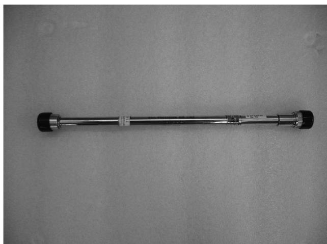
写真1 エアラインの例 (N型: 全長 30cm)
