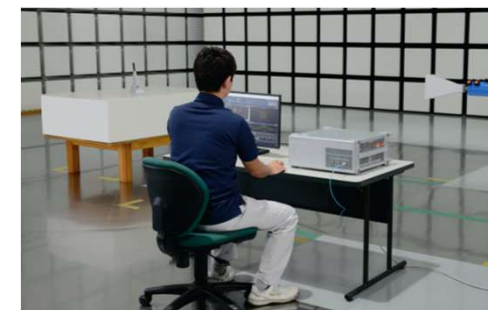
電波暗室での端末評価の様子
