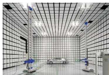
電波暗室 (20.9m x 12.9m x 7.25m)
