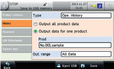
Exporte estadísticas combinadas de la controladora de peso y el detector de metales, historial de inspecciones y ajustes a un USB.
