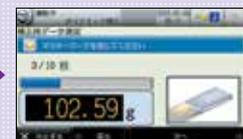
作業内容をイラストを用いてわかりやすく案内。手順にそって1ステップずつ作業を進め、正常に設定されないと動作しない仕組みになっています。設定ミスを抑制し、異常な設定状態のまま稼働させてしまうことを防止します。
