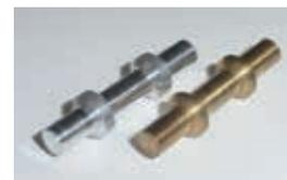
各秤に、500 mg と 2000 mg の二つの内蔵おもりを搭載しています。測定範囲の上下限に近いおもりを使うことで秤の直線性が確認できます。
