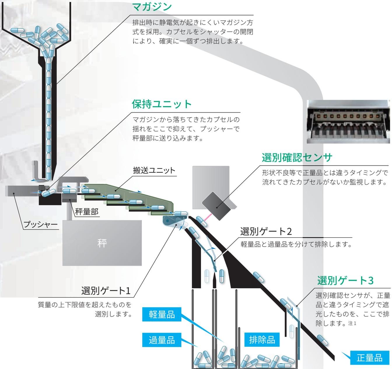
注1) アラーム停止後、運転再開したときに秤量部と搬送ユニットにあったカプセルも強制排除します。
