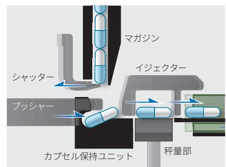
マガジン内のカプセルをシャッターにより一個ずつ下に落とします。保持ユニットでカプセルを保持し、落下時に発生した揺れを抑えてプッシャーで秤量台に送り出します。
