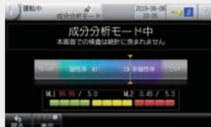
異物が混入した錠剤・カプセルを破壊することなく、異物が磁性体・非磁性体のどちらに近いかが確認できます。従来は、特殊な検査装置で破壊試験を行うとともに、異物の同定を行っていましたが、結果が出るまでに時間がかかっていました。本機能を使用することで、破壊試験を行う前に異物の傾向を確認できるため、迅速な金属異物の同定をサポートします。
