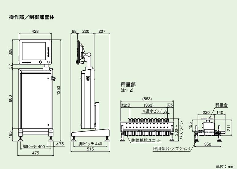
注1) 本図の秤ユニットは12連の場合の寸法になります。注2) 秤量台、秤用架台の形状にともなう( )内の寸法は仕様により異なります。詳細な寸法はお問い合わせください。
