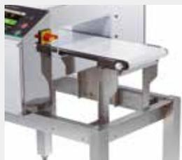
ゴミの溜まりにくいオープンフレーム構造を採用、清掃性を高め衛生面に配慮しました。防水モデルはIP66準拠。
