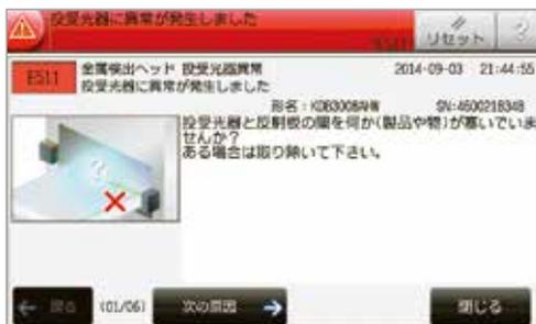
トラブルが起きると、その原因と処置方法をイラスト入りで説明。サービスマンを呼ぶ必要がなくなり、生産ラインの停止時間が短くすみます。
