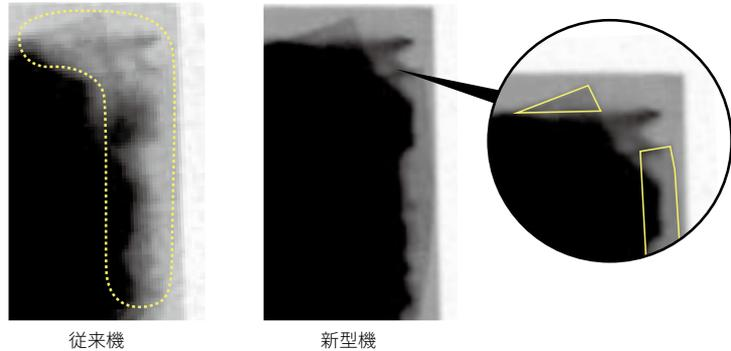
X線制御技術により、X線の漏洩を最小限に抑えることができ、商品の高さが10mm以下の場合にはカーテンに触れずに搬送することが可能になりました。これまで課題だったX線漏洩防止カーテンによる商品の搬送姿勢の乱れによる誤検出を防止します。さらに、選別タイミングがずれることも無く、不良品を確実に選別します。
