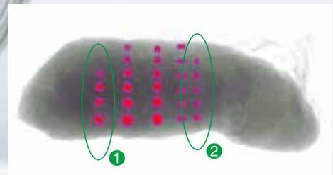
テストピースによる豚ヒレ肉(500g)の検査画像。微小なイロン球①やSUS球②も高感度に検出しています。
