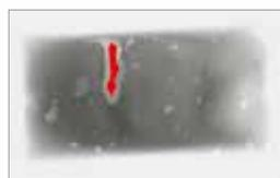
レトルト商品の気泡で最小10cc、固形商品で最小φ2mmの気泡/空洞も検出可能。
