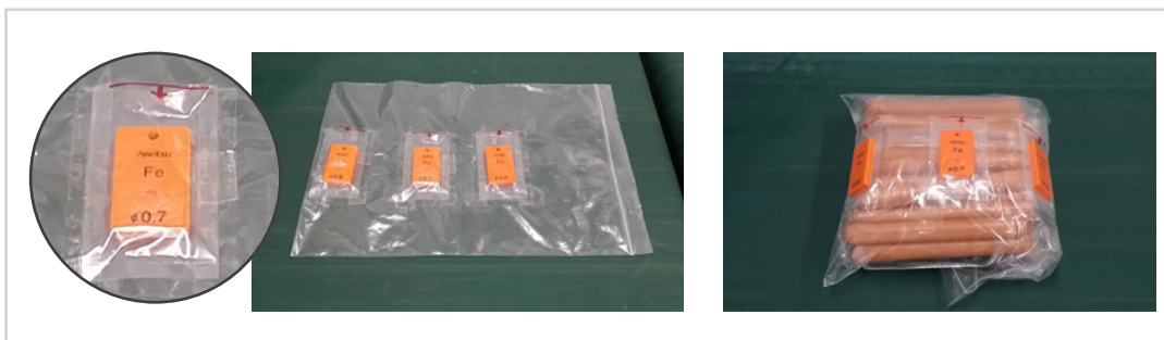
図 2-1：ポケット方式のテストピース装着治具（注：実際の運用は、テストピース 1 つだけ使用します）
