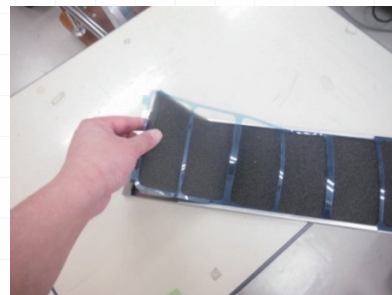
図4 フィルタ（外して清掃）
