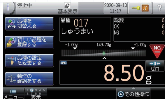
図14 米粒でゼロ点がプラスにずれた状態
