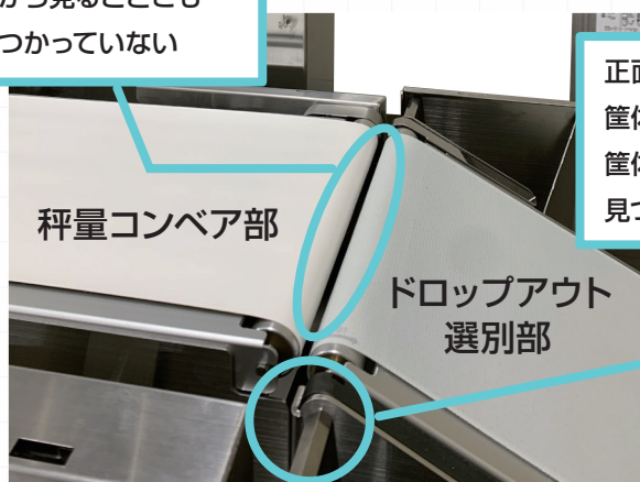
図3 ドロップアウト選別部が秤量コンベア部に接触
