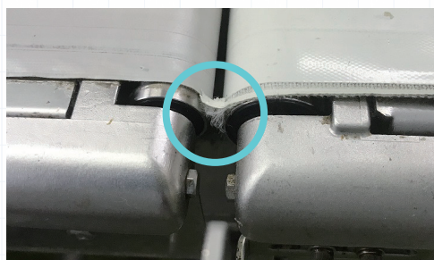
図5 ほつれが秤量コンベア部に接触
