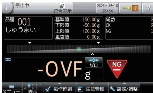
図10 カバー着け忘れによるゼロセット異常
