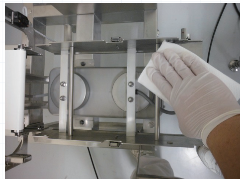
図16 コンベアを外し、受台の清掃
