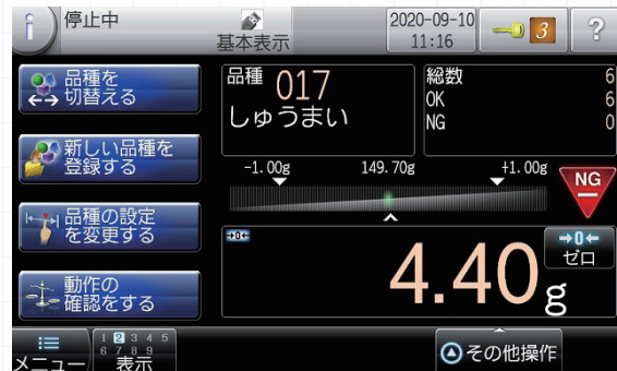
図12 ラベルでゼロ点がプラスにずれた状態
