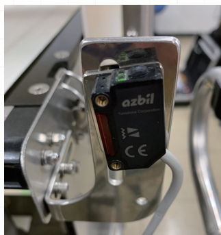
図15 投受光器が上に傾いた状態
