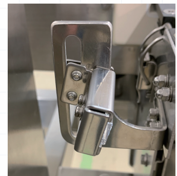
図16 反射板が下に傾いた状態
