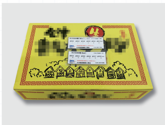
【SUS 線、SUS 球テストピースを貼った状態】
