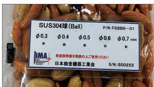
【リミットを下げることで \phi 0.4\text{mm} を検出】
