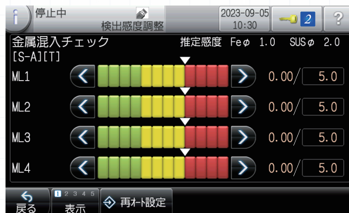
インバータノイズによりインジケータが振り切っている状態
