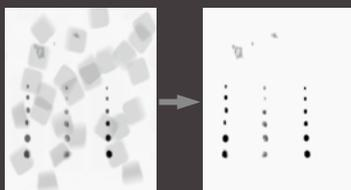
通过获取在高 / 低 2 种的能量带获得的透视图像的差异部分，可以明确地仅显示出异物
