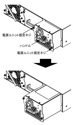
図 4.2.1-1 電源ユニットの取り外し
