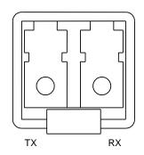
図 A.5-1 10GBASE-LR モジュール正面図
