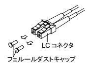
図 2.5.3.1-2 フェルールダストキャップの取り外し
