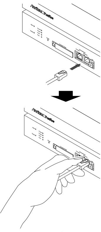
図 2.6.1-1 UTP ケーブルの接続
