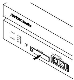
図 2.7-4 CF キャップの取り付け
