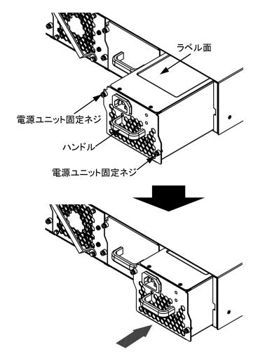
図 4.2.2-1 電源ユニットの取り付け
