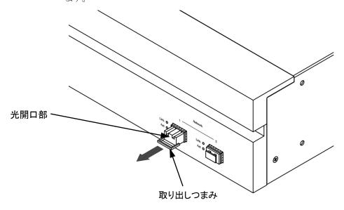
図 2.5.2.2-1 SFP モジュールの取り外し
