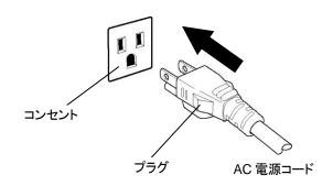
図 3.1-2 AC 電源コードの接続(コンセント)
