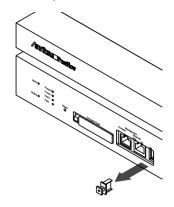
図 2.8-1 USB キャップの取り外し
