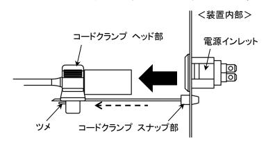
図 3.4-2 AC 電源コードクランプの取り外し
