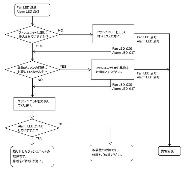
図 5.2.2-1 Fan LED 点滅時異常探求フロー
