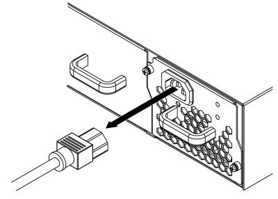
図 3.4-3 AC 電源の切断(インレット)
