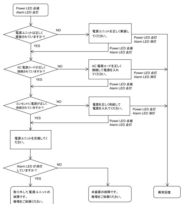
図 5.2.1-1 Power LED 点滅時異常探求フロー
