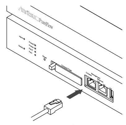
図 3.3.1-1 コンソールケーブルの接続(装置側)
