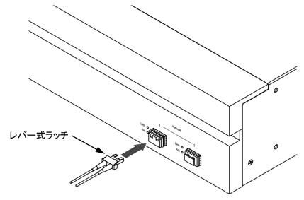
図 2.5.3.1-3 光ファイバケーブルの差し込み
