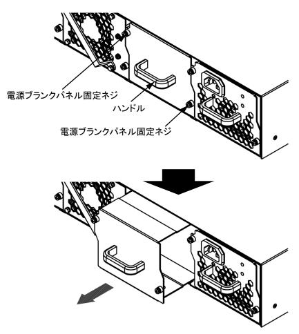
図 4.3.1-1 電源ブランクパネルの取り外し
