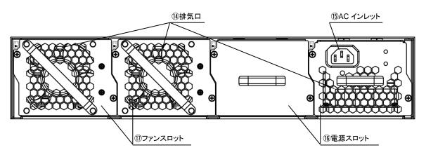
図 1.3-2 装置背面図と各部の名称
