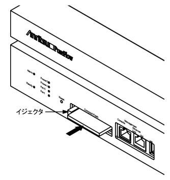
図 2.7-2 CF カードの挿入
