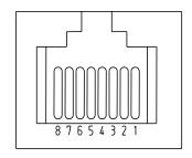
\*装置正面コンソールポート嵌合面から見た図図 A.1-1 ピン配置
