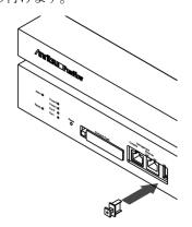
図 2.8-4 USB キャップの取り付け
