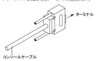
図 3.3.1-2 コンソールケーブルの接続(ターミナル側)
