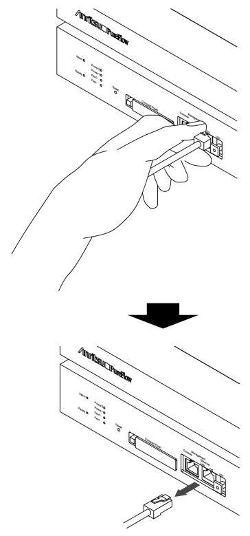
図 2.6.2-1 UTP ケーブルの取り外し
