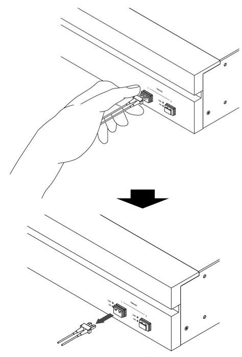
図 2.5.3.2-1 光ファイバケーブルの取り外し
