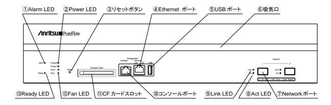
図 1.3-1 装置正面図と各部の名称
