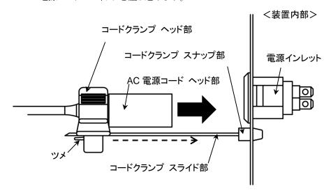
図 3.1-4 AC 電源コードのクランプ
