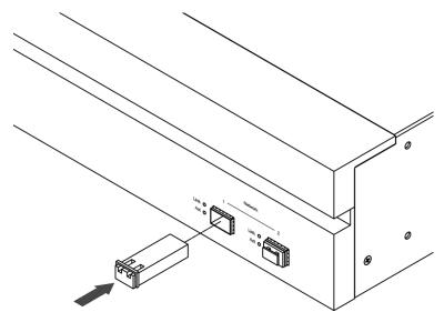
図 2.5.2.1-2 SFP モジュールの挿入
