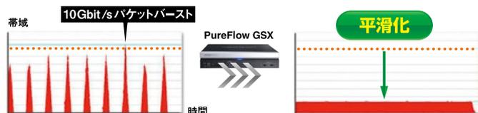
マイクロ秒のスケジューリング精度でパケット送出タイミングを調整
