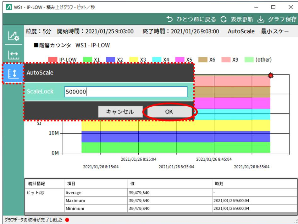
図 4.5.3-2 表示データスケールの変更(ScaleLock)
