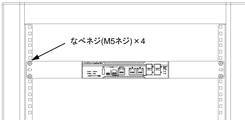
図 2.4.2.1-4 19 インチラックへの装置搭載 (EIA, IEC 規格)
