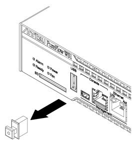
図 2.10-1 USB キャップの取り外し
