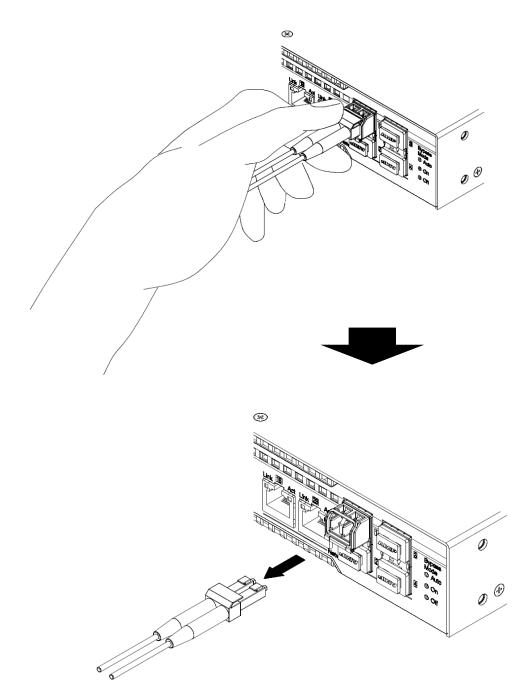
図 2.7.2-1 光ファイバケーブルの取り外し
