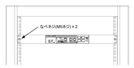
図 2.4.2.1-5 19 インチラックへの装置搭載(JIS 規格)
