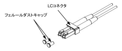
図 2.7.1-2 フェルールダストキャップの取り外し
