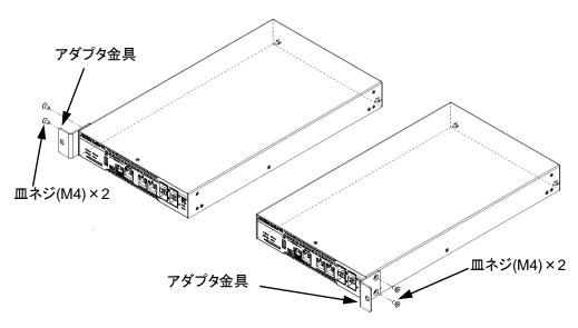
図 2.4.2.2-2 アダプタ金具の取り付け
