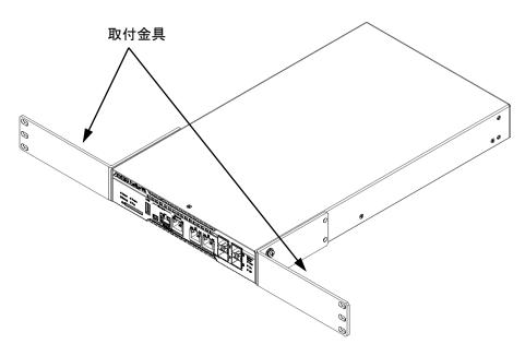
図 2.4.2.1-1 取付金具の取り付け
