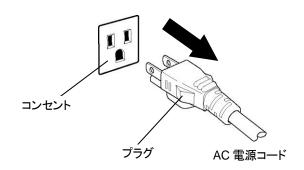
図 3.3-1 AC 電源の切断(コンセント)
