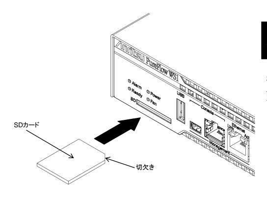
図 2.9-2 SD カードの挿入
