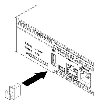
図 2.10-4 USB キャップの取り付け
