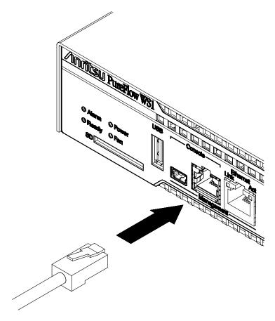
図 3.2.1-1 コンソールケーブルの接続(装置側)
