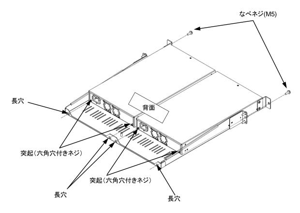
図 2.4.2.2-3 トレーへの装置搭載
