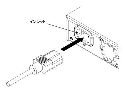
図 3.1-1 AC 電源コードの接続(インレット)
