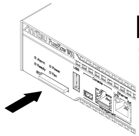
図 2.9-4 SD キャップの取り付け
