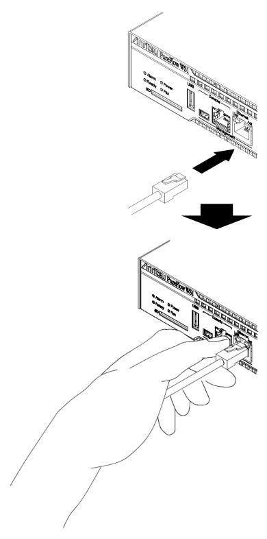
図 2.8.1-1 UTP ケーブルの接続
