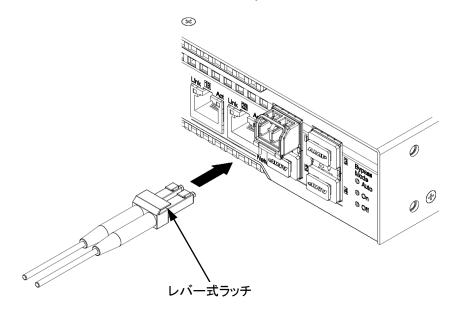
図 2.7.1-3 光ファイバケーブルの差し込み
