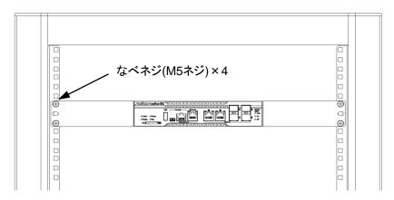
図 2.4.2.1-4 19 インチラックへの装置搭載(EIA, IEC 規格)
