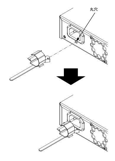
図 3.1-3 AC 電源コードクランプの取り付け
