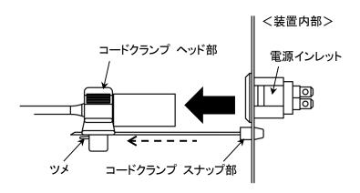
図 3.3-2 AC 電源コードクランプの取り外し
