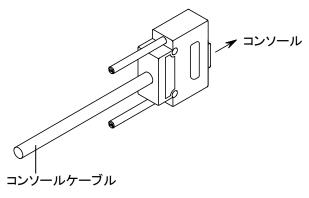
図 3.2.1-2 コンソールケーブルの接続(コンソール側)
