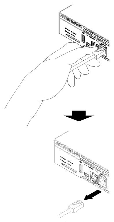
図 2.8.2-1 UTP ケーブルの取り外し
