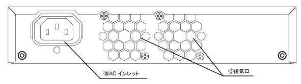
図 1.3-2 装置背面図と各部の名称
