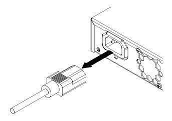
図 3.3-3 AC 電源の切断(インレット)
