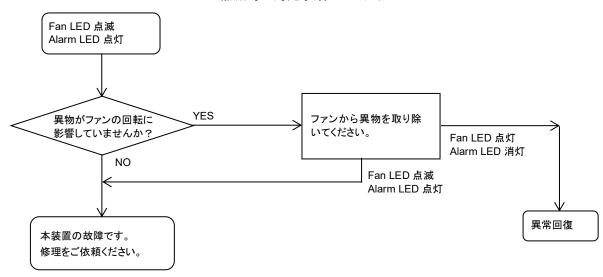
図 4.2.1-1 Fan LED 点滅時異常探求フロー
