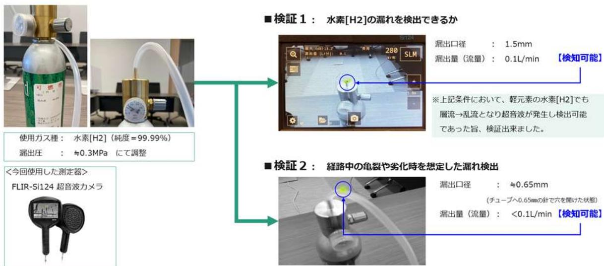
図 8 アンリツによる FLIR Si124 を用いて水素の漏れを検知させる実験の結果
