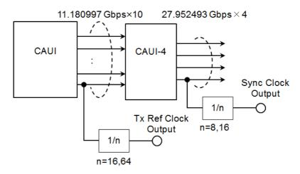
Block Diagram of Tx Part (QSFP28)
