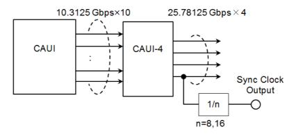
Block Diagram of Tx Part (QSFP28)
