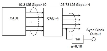
Block Diagram of Tx Part (SFP28, QSFP28)
